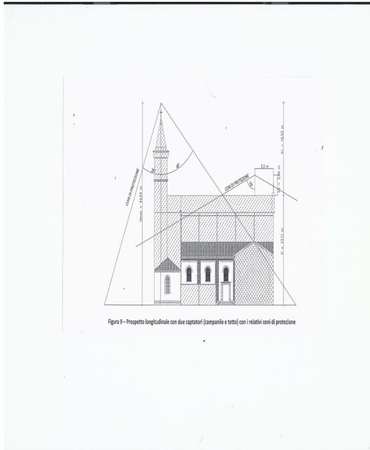
**Studio sulla protezione della Chiesa da parte di un sistema di parafulmini e scaricatori**
